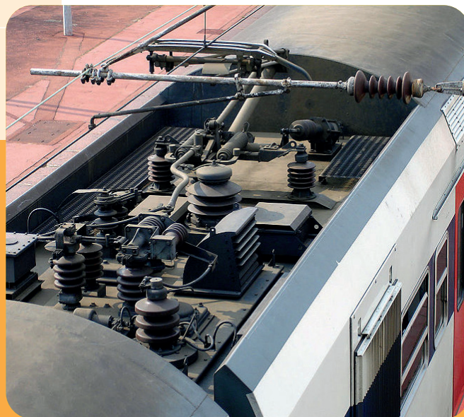
Lubrification dynamique, sous HT, de pantographes.
